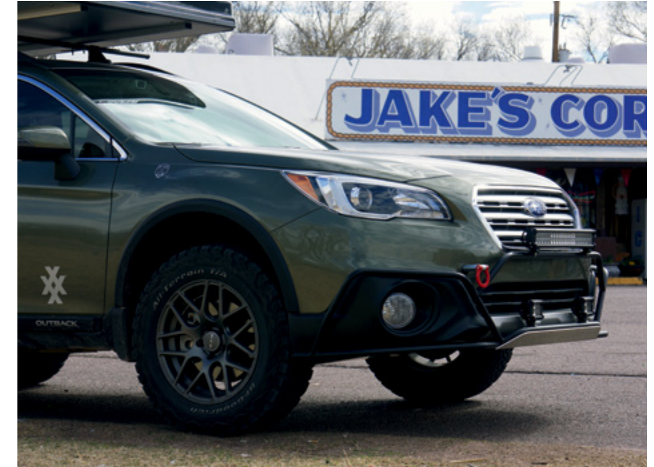
Металлический каркас вокруг бампера больше служит для крепления светодиодных прожекторов, чем защиты пластика
